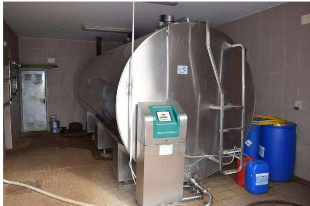
Затем показали ребятам холодильник-хранилище, в котором поддерживается определенная температура, необходимая для хранения молока, до тех пор, пока приедут машины и увезут его на молочный завод.
